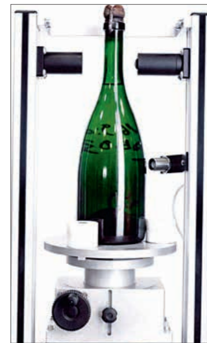
Aphromètre laser utilisé pour mesurer la pression in situ (méthode non destructive).
